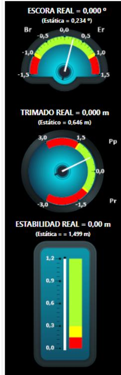
Realiza automáticamente el cálculo de todas las averías reglamentarias cada vez que se introduce una condición de carga del buque intacto, y emite mensaje de todos los posibles incumplimientos en cada una de las averías.
